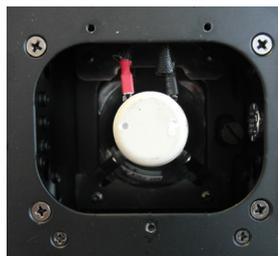
Ne pas toucher la lampe avec les doigts le plus simple et d'utiliser une paire de gants propre pour le remplacement de la lampe. Les salissures et les traces de gras peuvent occasionner la destruction ou une sérieuse diminution du temps d'utilisation.
