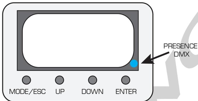
L'ensemble des fonctions et des commandes sont accessibles grâce aux Quatres boutons Les fonction sont visualisées par l'afficheur .
