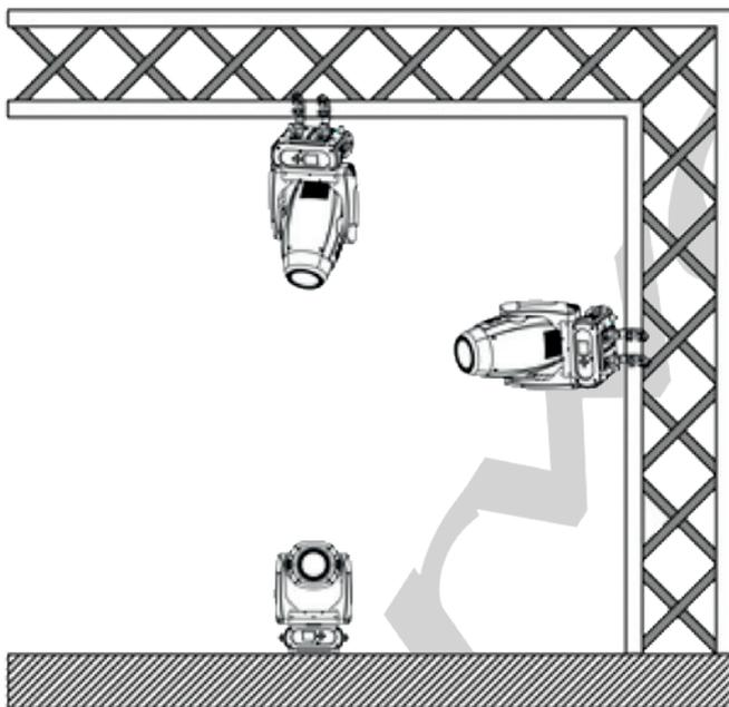
L'appareil peut être posé, accroché horizontalement, verticalement.
