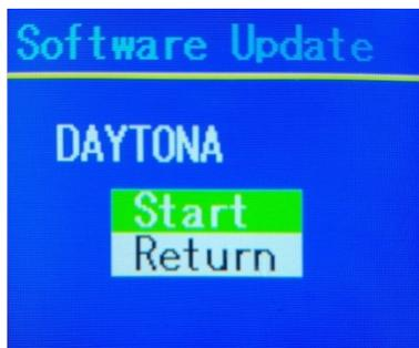
**Nota bene :** Il est possible de mettre a jour plusieurs machines en meme temps en les connectant sur la maitre en dmx. Attention ne pas connecter de console et couper le Wireless si présent.
