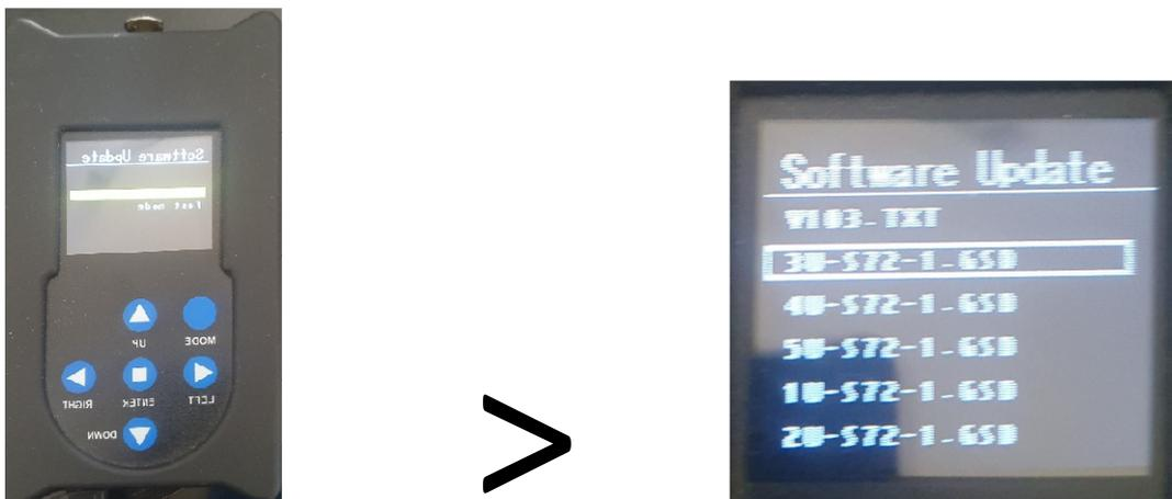
4- Sélectionner le menu start puis allumer les machines. Les machines vont afficher « connexion » et rester en attente du nouveau software. Appuyer sur enter et attendre la fin du chargement du premier fichier.
