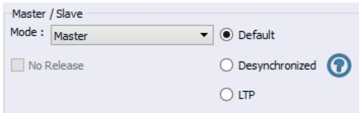
**Le mode autonome permet de configurer les interfaces** en maître ou esclave lorsque plusieurs interfaces sont connectées sur les ports USB. Ce mode permet de connecter entre eux plusieurs appareils et ainsi augmenter le nombre d'univers (jusqu'à 32 univers). Les interfaces sont toujours
